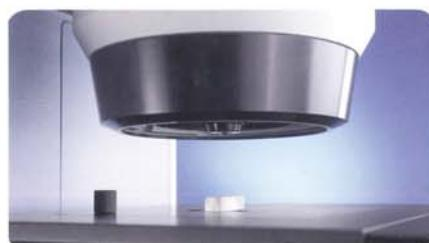
LUMOS包括一个智能物镜，该物镜可用于透射、反射及ATR模式下的可见光观察和红外测量。在透射与反射模式下，ATR晶体隐藏在物镜里；在ATR模式下，ATR晶体则自动置于红外光路焦点处，进行背景数据的采集。同时，ATR镜头内置的压力控制单元可以确保ATR晶体对样品的压力保持恒定，
