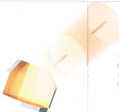
三维立体角镜不受镜面倾斜的影响，入射光与反射光达到绝对平行。这是布鲁克光谱仪器公司RockSolid™干涉仪永久准直的基本原理。
